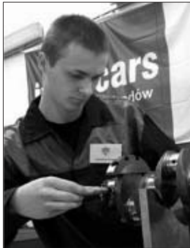
Uczeń ZSZ nr 1 z Bychawy Sebastian Krupa dokonuje weryfikacji czopów wału korbowego.
